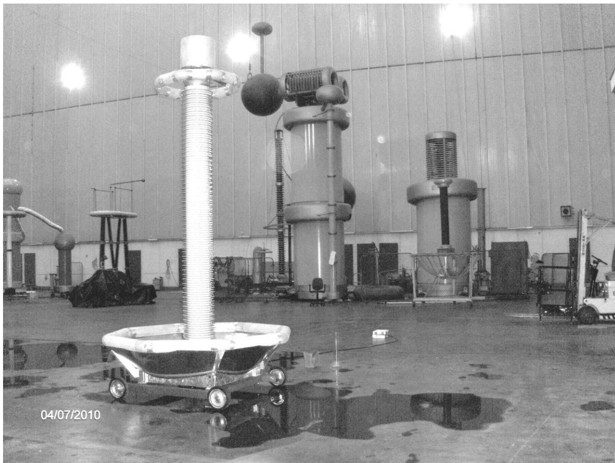
Rys. 6. Dzielnik napięcia podczas prób napięciem udarowym łączeniowym pod deszczem.
